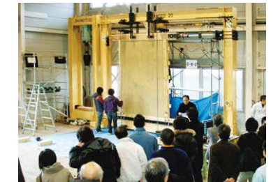
土壁の耐力試験
