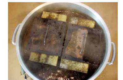
接着重ね梁の接着性能試験
