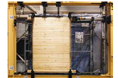
床構造体の水平耐力試験
