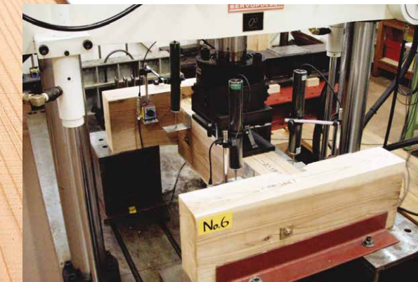
接合部の強度性能試験
