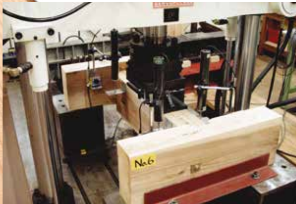
接合部の強度性能試験
