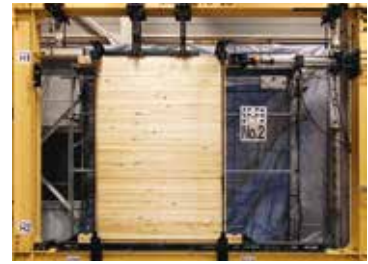
床構造体の水平耐力試験
