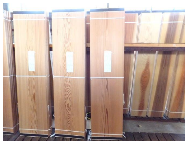
魚梁瀬杉の天井板
