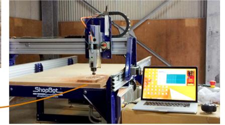
CAD図面を読み込みCNCミリングマシンでくり貫くように製作。コンピュータによる技術を最大限活かすことで、部取りよくスピーディに製作することが可能です。
